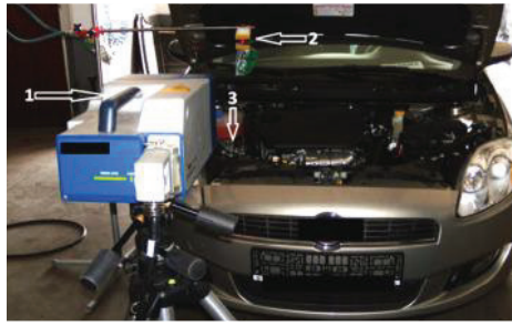
کاربرد ارتعاش سنج لیزری در تشخیص‌های مکترونیک خودرو
